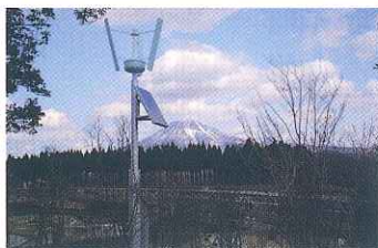
マイクロ風車 現地据付状態
